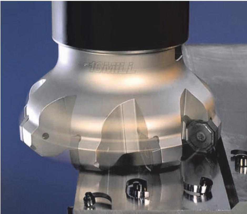
Das Bild zeigt das Planfräswerkzeugsystem 16MILL und hier das bei HWF im Einsatz befindliche Werkzeug mit 80 mm Durchmesser F45NM DO80-06-27-R08
