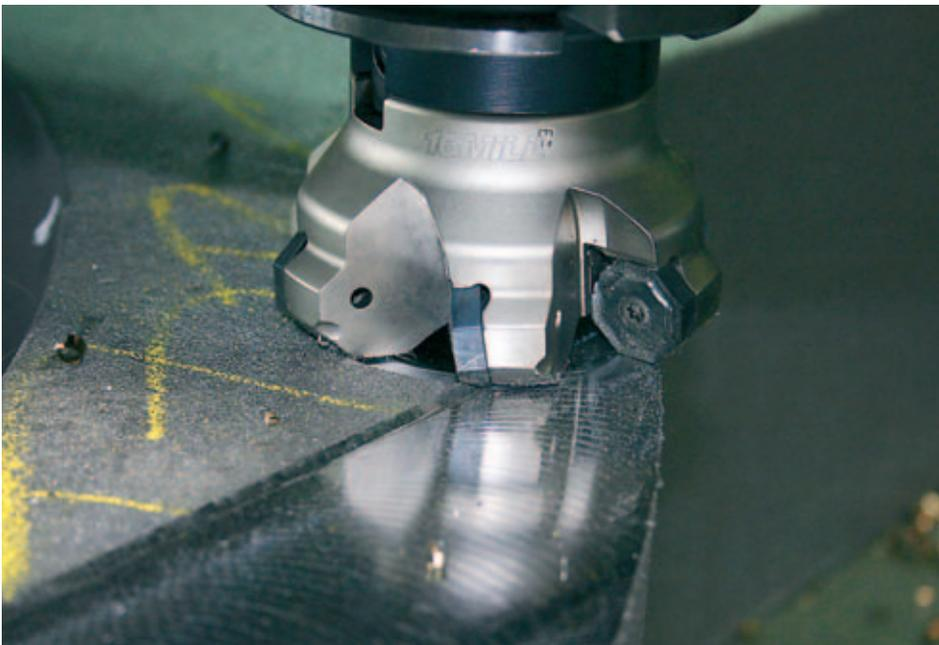
Im Bild das Planfräsen eines großen Werkzeugteils aus GG 25 auf einer leistungsschwachen Großteile-Fräsmaschine mit dem weichschneidenden Planfräser 16MILL sowie Wendeschneidplatten mit 16 Schneiden
